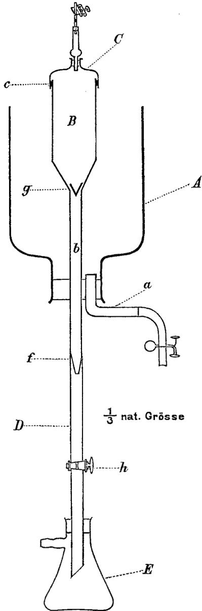
nur unter Abschluss der Feuchtigkeit, sondern auch dem des Sauerstoffs operirt werden, so kann vor der Beschickung des Apparates die Luft von *E* aus durch ein indifferentes Gas verdrängt und dieses auch nach beendigtem Versuch von *C* aus eingeführt werden.
